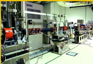
**2 เครื่องเร่งอนุภาคแนวตรง (Linear Accelerator : Linac)**
